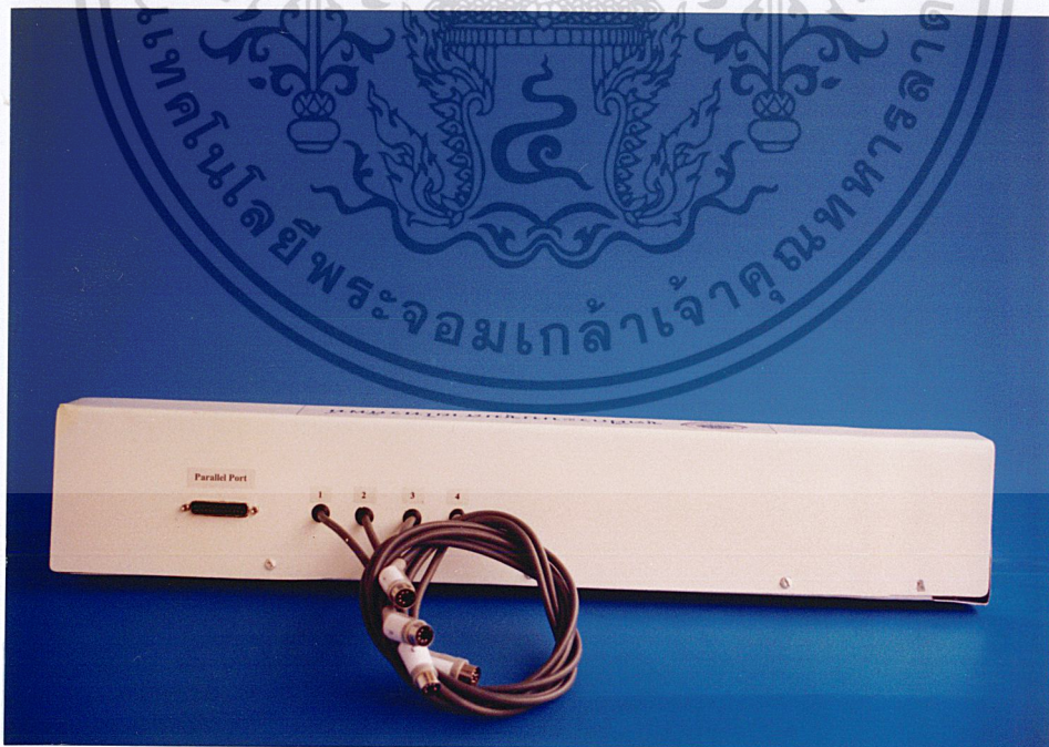
รูปที่ ก.12 ชุดฝึกระบบชุมสายโทรศัพท์ (ด้านหลัง)
