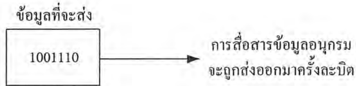
รูปที่ 2.3 การส่งข้อมูลแบบอนุกรม จำนวน 8 บิตจะส่งทีละบิตจนครบ 1 ไบต์
