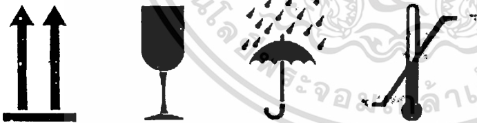
ภาพที่ 2 แสดงสัญลักษณ์ที่ใช้ในการขนถ่ายขนส่ง
