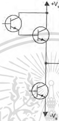
รูปที่ 2.30 การออกแบบภาคเอาต์พุตแบบมีส่วนประกอบเต็มส่วนเพียงกิ่งเดียว
