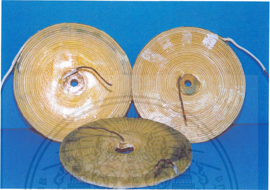
รูปที่ ข.13 แสดงลักษณะของขดลวดเหนียวนำที่ทำจากลวดทองแดงพร้อมทั้งสวมปลอก ฉนวนทนความร้อนแล้วทาภายนอกด้วย epoxy
