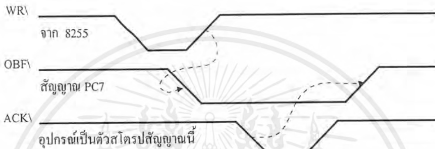
รูปที่ 2.43 (a) แผนภาพสัญญาณติดต่อเพื่อส่งข้อมูลออกไปจากพอร์ต A ของ 8255 ตามลักษณะการทำงานที่ได้กำหนดไว้จากตาราง 2.20
