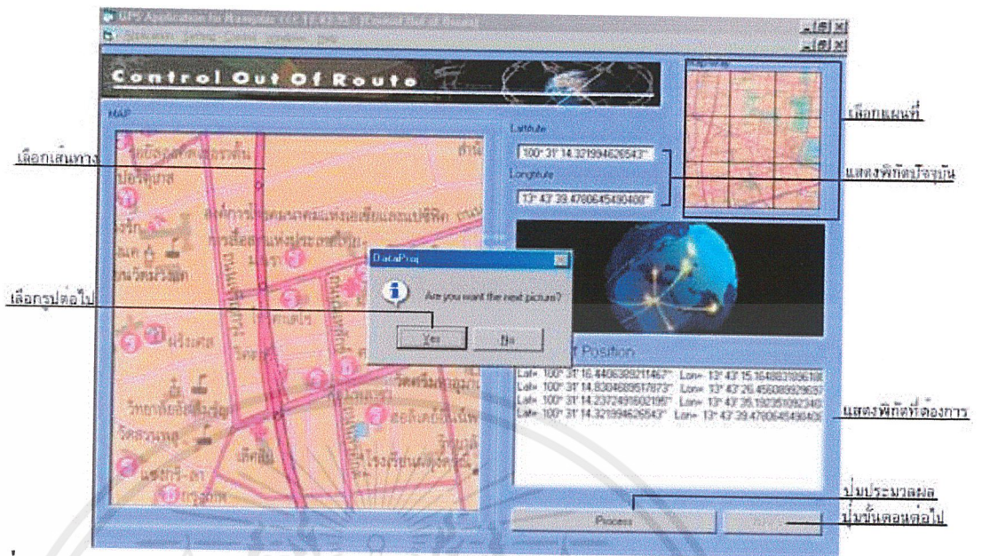
รูปที่ 6.4 หน้าต่างส่วนของ Control out of Route พร้อมคำอธิบาย และข้อความขึ้นแผนที่ใหม่
