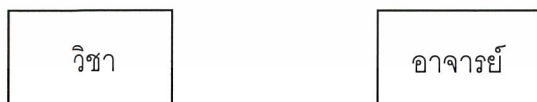
รูปที่ 2.1 แสดงสัญลักษณ์ที่ใช้สำหรับเอนทิตี
