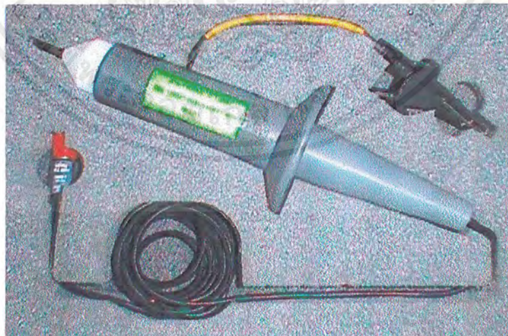
รูปที่ 3.13 โพรบที่ใช้ในการวัดไฟฟ้าแรงดันสูง (PROBE x 1000)
