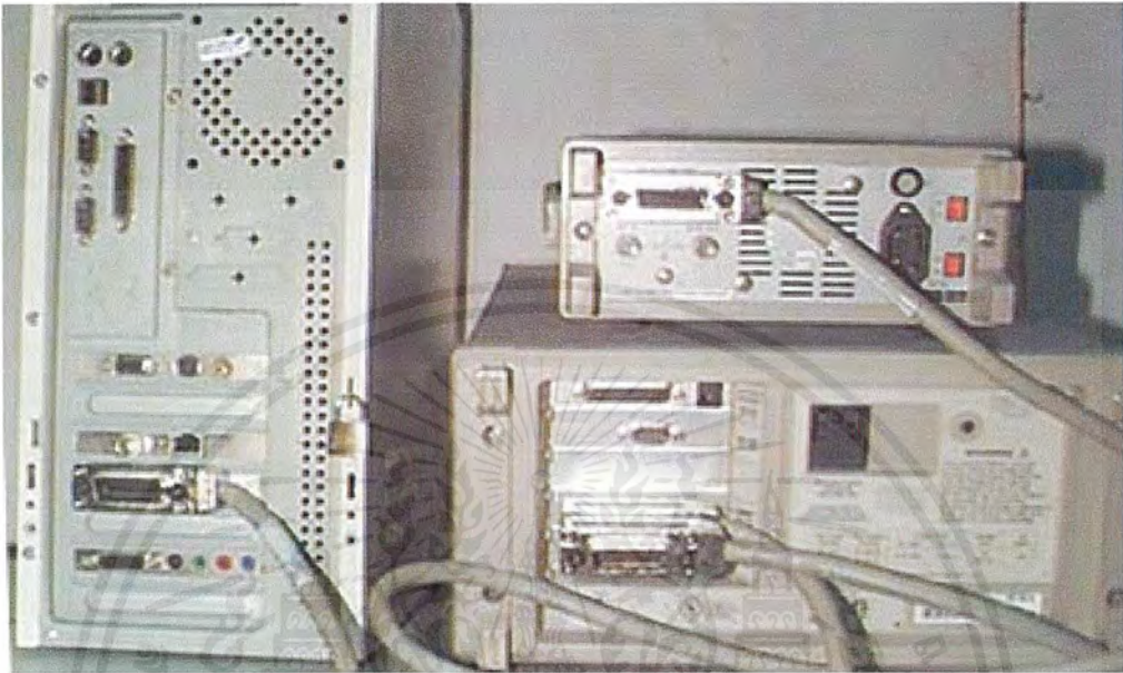
รูปที่ 4.10(ก) ลักษณะการเชื่อมต่อเครื่องมือวัดเข้ากับเครื่องคอมพิวเตอร์
