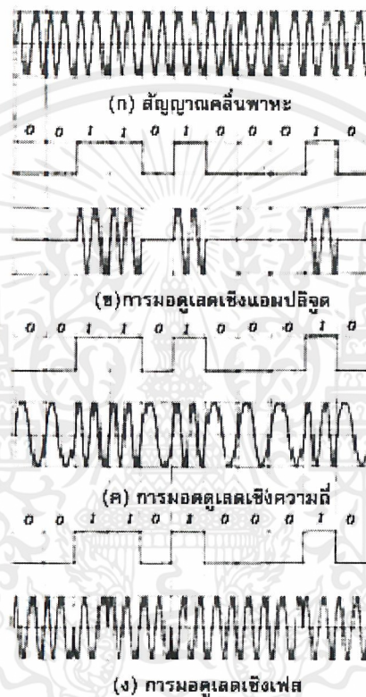
รูปที่ 2.6 แสดงการมอดูเลตสัญญาณแบบต่างๆ
