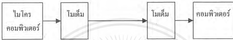
รูปที่ 2.37 การใช้ RS 232C เชื่อมต่ออุปกรณ์
