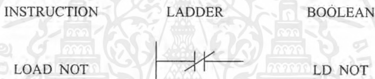
รูปที่ 1.2 แสดงโครงสร้างของคำสั่ง LD NOT
