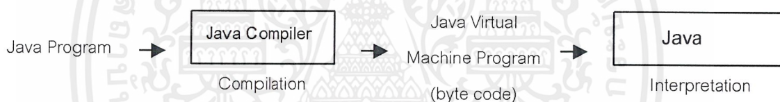
รูปที่ 2.5 แสดงการแปลงจากโปรแกรมจาวาไปเป็นโปรแกรมของ Java Virtual Machine
