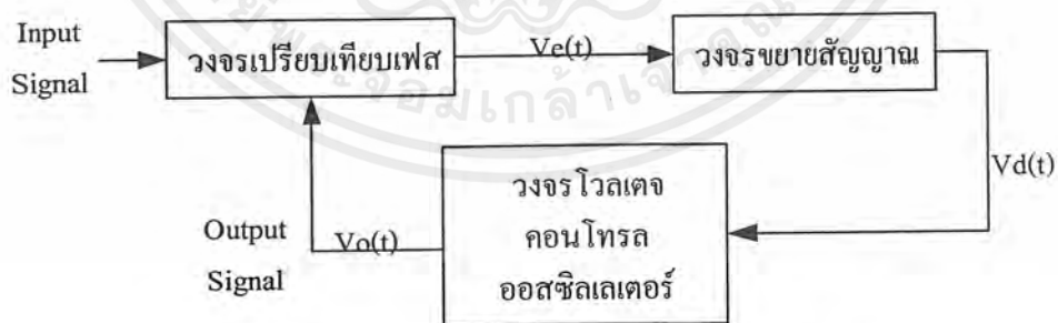
รูปที่ 3.14 บล็อกไดอะแกรมแสดงการทำงานของเฟสล็อกคลุปร
