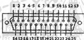
รูปที่ 4.4 คอนเน็กเตอร์อนุกรม 25 ขาหรือ DB-25
