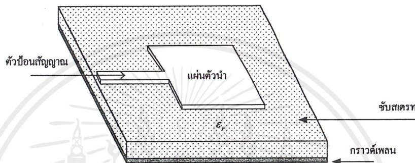
รูปที่ 2.3 แสดงส่วนป้อนสัญญาณกลับของไมโครสตริป (Microstrip Line Feed)
