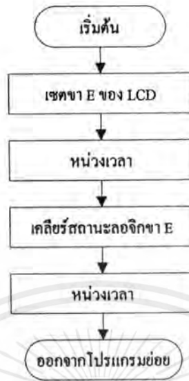
รูปที่ 3-5 โฟลวชาร์ต โปรแกรมย่อยส่งพัลส์อีนาเบลให้แก่โมดูล LCD
