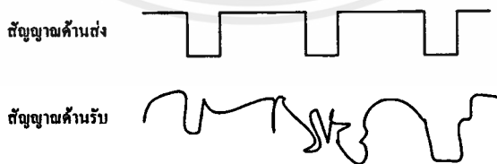
รูปที่ 1.5 กรณีที่เกิดการผิดเพี้ยนรูปทรงของสัญญาณอย่างมาก
