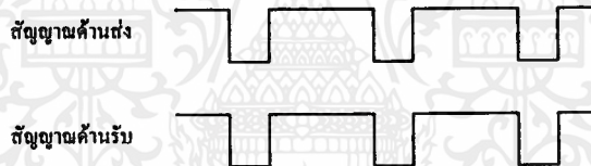
รูปที่ 1.4 กรณีที่ไม่มีการผิดเพี้ยนรูปทรงของสัญญาณ
