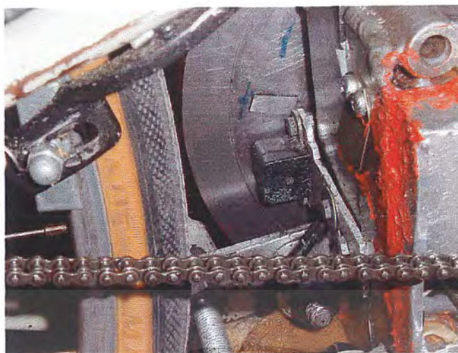
รูปที่ 3-17 การติดตั้งพัลเซอร์
