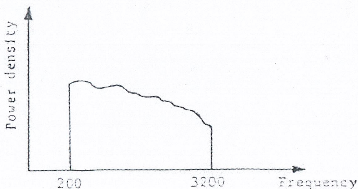
รูปที่ 1.1 แสดง Power Spectrum Density ของสัญญาณเสียงก่อนการสแกรมบลิ้ง
