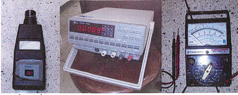
รูปที่ 5-7 เครื่องมือวัดค่าความเร็วรอบ (Tachometer) มัลติมิเตอร์ (Multimeter) และโวลท์-โอห์ม มิเตอร์ (Volt-Ohm Meter)
