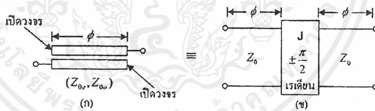
รูปที่ 2.46 วงจรสมมูลระหว่าง (ก) paralleled coupled line กับ (ข) Admittance inverters
