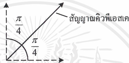
รูปที่ 2.6 สัญญาณควิพีเอสเคถูกเลื่อนเฟสไป \pi/4
