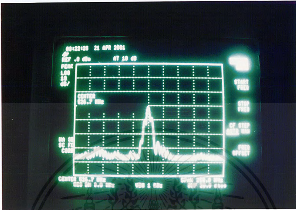
รูปที่ 4.4 สัญญาณอาร์เอฟวัดได้จากเครื่องวิเคราะห์สัญญาณสเปกตรัมที่ปลายสาย ด้วยระยะทาง 100 เมตร โดยการส่งจากเครื่องที่ 1
