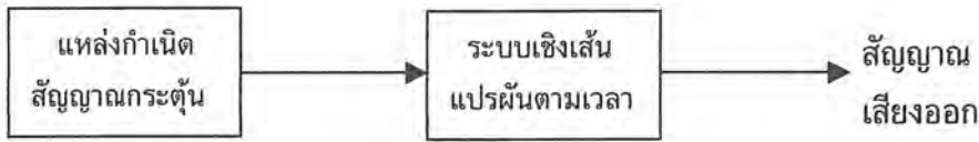
รูปที่ 2.5 แผนภาพกรอบจำลองระบบกำเนิดเสียงเริ่มต้น
