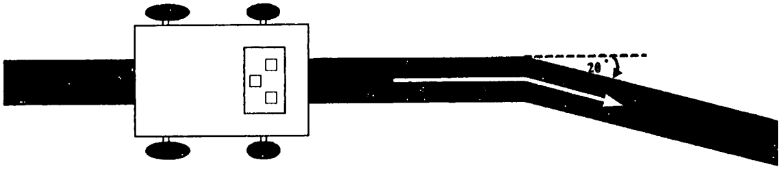
รูปที่ 4.6 ทิศทางของหุ่นยนต์ให้เคลื่อนที่เลี้ยวขวาเมื่อใช้เซ็นเซอร์ 2 ตัว
