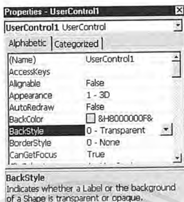
รูปที่ 4-6 พร็อพเพอร์ตี้ BackStyle และ ToolboxBitmap
