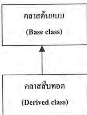
รูปที่ 2-1 การสืบทอดจากคลาสต้นแบบไปเป็นคลาสสืบทอด
