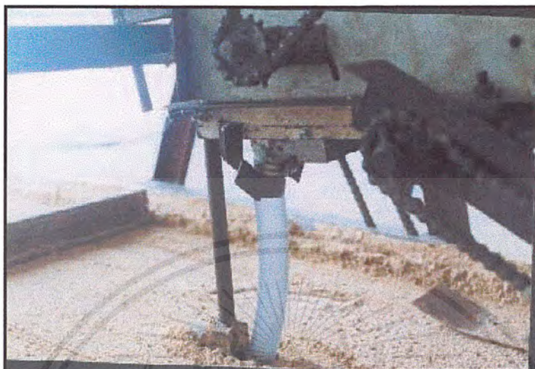
รูปที่ 3.16 แสดงท่อนำเมล็ดขนาดเส้นผ่านศูนย์กลาง 2.5 เซนติเมตร
