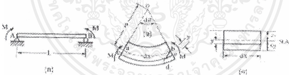
รูปที่ 2.23 ความเค้นดัดกระทำปลายทั้งสองข้าง
