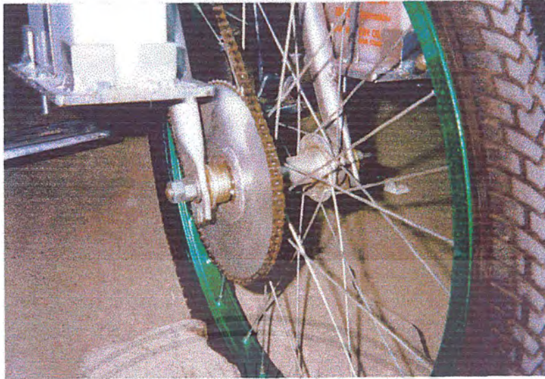
รูปที่ 4.8 นำล้อมาใส่สเตอร์
