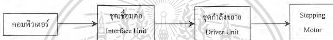
รูปที่ 2.5 Block Diagram แสดงการควบคุม Stepping Motor
