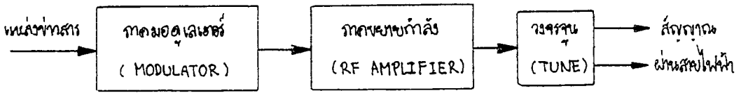
รูป ๑.๒ บล็อกไดอะแกรมการทำงานของเครื่องส่ง
