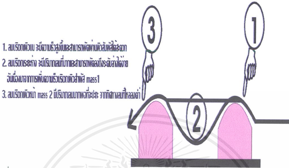
รูปที่ 4.26 แสดงการวิเคราะห์รูปทรงหลังคาโค้ง
