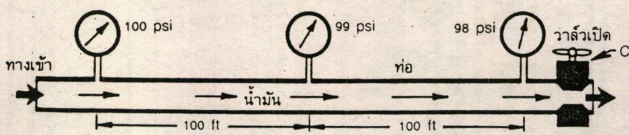
รูปนี้แสดง ความเสียดทานที่ผนังท่อทำให้เกิดความดันลดลง
