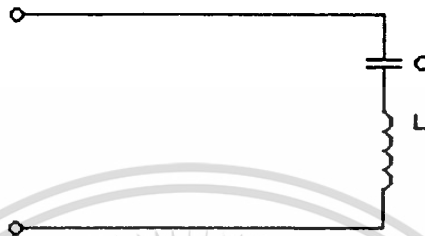
รูปที่ 2.35 วงจร RC Series Resonance
