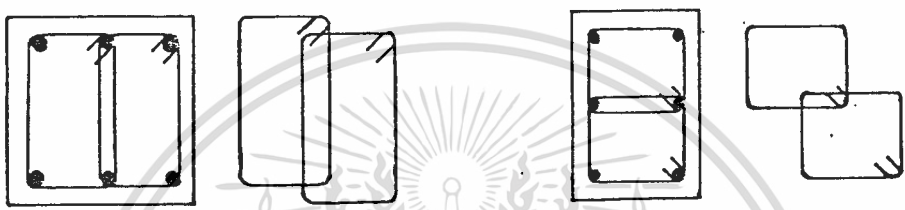
เหล็กยี่น 6 เส้นเหล็กปลอก 2 เส้น
