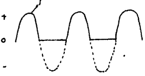
รูปที่ 3 แสดงลักษณะการทำงานของไดโอดสำหรับ วงจรของระดับไฟกระแสสลับที่ป้อนให้กับวงจรเรียงกระแสแบบครึ่งคลื่น โดย
