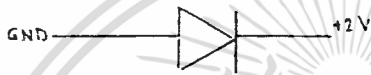
รูปที่ 4.6 แสดงลักษณะการไบแอสที่จะทำให้แอลอีดีเปล่งแสง
