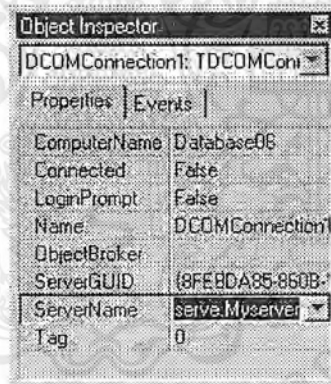
รูปที่ 4-7 แสดงการกำหนดพรอพเพอร์ตี้ของ DCOMConnection
