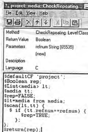
รูปที่ 3-26 แสดงเมทอด CheckRepeating ที่แก้ไขเสร็จแล้ว
