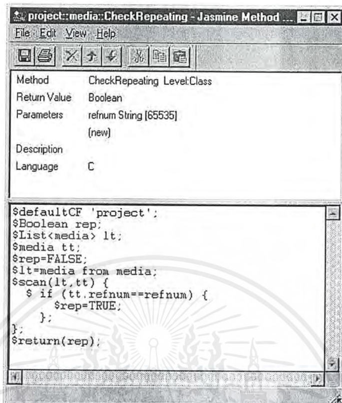
รูปที่ ค-1 แสดงเมทอด CheckRepeating ของคลาส media
