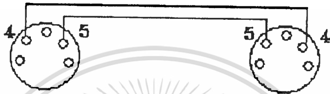
รูปที่ 3.2 ลักษณะการต่อสายสัญญาณกับแจ็คดิน
