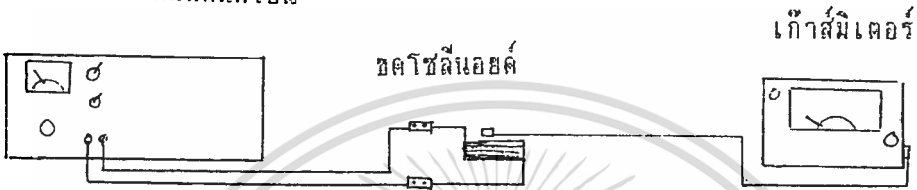
รูปที่ 4.3 แสดงการวัดค่าสนามแม่เหล็กจากชดเชยชิลินอยด์
