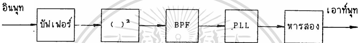
รูปที่ 3.7 แผนผังแสดงการทำงานของวงจรสร้างสัญญาณพาร์กกลับมาใช้
