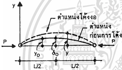
รูปที่ 2.16.2 เสาโค้งภายใต้แรงอัด
