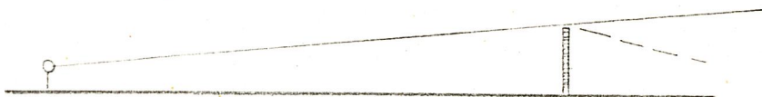
รูปที่ 38 แสดงการกำหนดตำแหน่งของแผงกันเสียงชนิดต่าง ๆ
