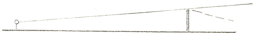
รูปที่ 38 แสดงการกำหนดตำแหน่งของแผงกันเสียงชนิดต่าง ๆ
