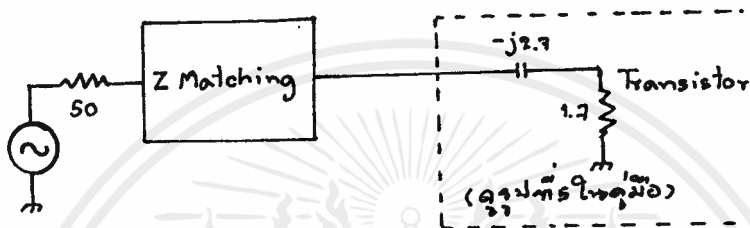
รูปที่ 3.12 แสดงวงจรเทียบเท่าทรานซิสเตอร์ทางด้านอินพุตตาม
