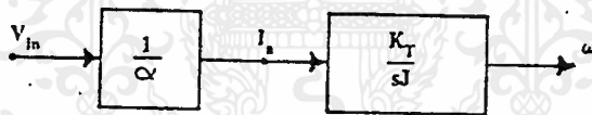
รูปที่ 7.47 บล็อกไดอะแกรมของทรานส์เฟอ์ฟังกชันของ PWM แอมพลิไฟเออร์และมอเตอร์ที่ได้ทำให้ง่ายขึ้นแล้ว
