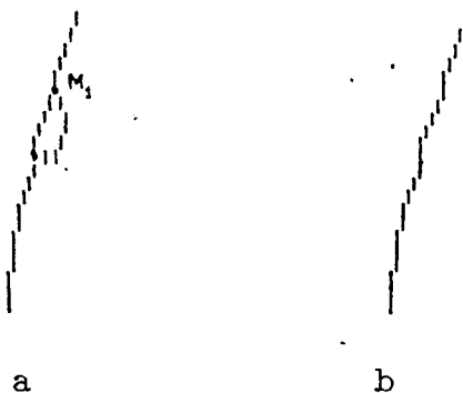
รูปที่ 3.6 a. ลักษณะลาย Loop b. ลักษณะลายที่ถูกต้อง
