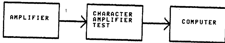
รูปที่ 1-2 หลักการเบื้องต้นของการทดสอบเครื่องขยายเสียงด้วยคอมพิวเตอร์
