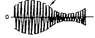
รูปที่ 2.1 การผสมสัญญาณระหว่างความถี่เสียงกับคลื่นพาหะ
