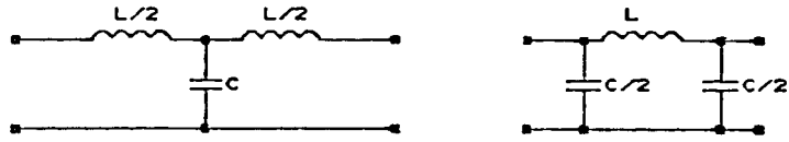
รูปที่ 2.5.3 Two-Pass Constant-K ในรูปของ T และ \pi
