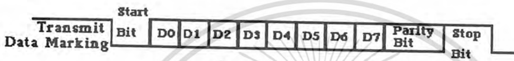
รูปที่ 4 ภาพแสดงการส่งข้อมูลแบบอะซิงโครนัส
